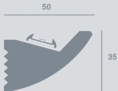
Profilé en plâtre haute densité pour éclairage indirect.
